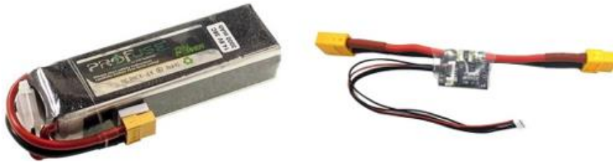
Şekil 9: LiPo pil ve güç dağıtım modülü
