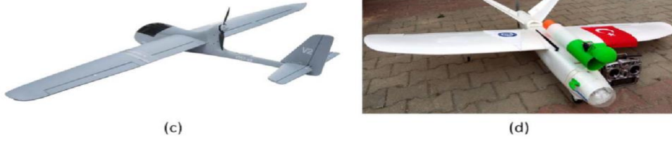
Şekil 1: Sabit Kanatlı İHA Görüntüleri: Önden Motorlu (a), Kanatlardan Motorlu (b), Üstten Motorlu (c) ve Arkadan İtişli (d)
