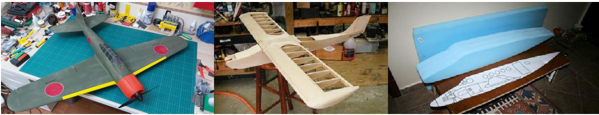
Şekil 5: Farklı malzemelerden yapılmış İHA'lar
