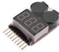
Şekil 14: Örnek Batarya Alarmı
